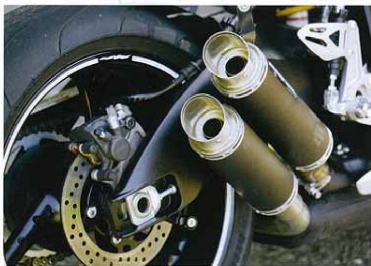
Doppelter Schalldämpfer von Bodis: macht die Hinterhand optisch und das Motorrad auch auf der Waage leichter.
